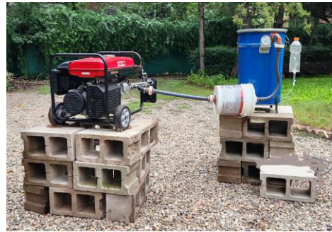
Moto-generador andando solo a "Gasura" y agua.
