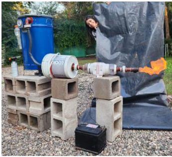
Purgado y venteo con el ventilador 12V.
