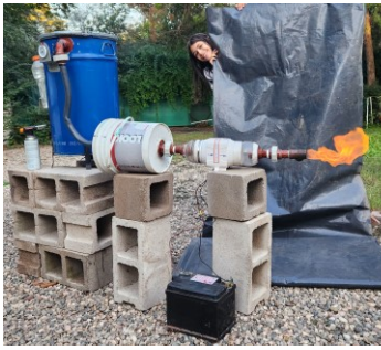
Purgado y venteo con el ventilador 12V.
