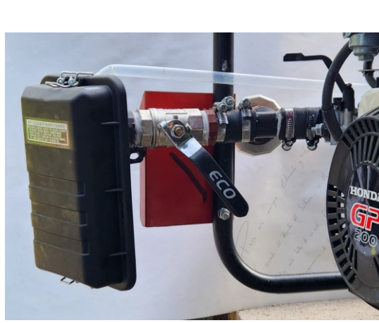
Adaptador instalado, válvula globo CASI CERRADA para Gasura.
