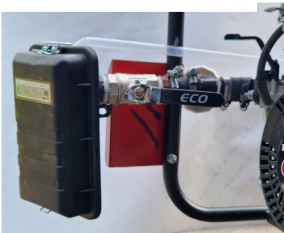
Adaptador instalado y válvula globo ABIERTA para gasolina.
