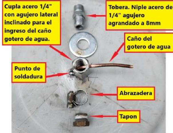
Despiece de Tobera gasificador para generador a Gasura
