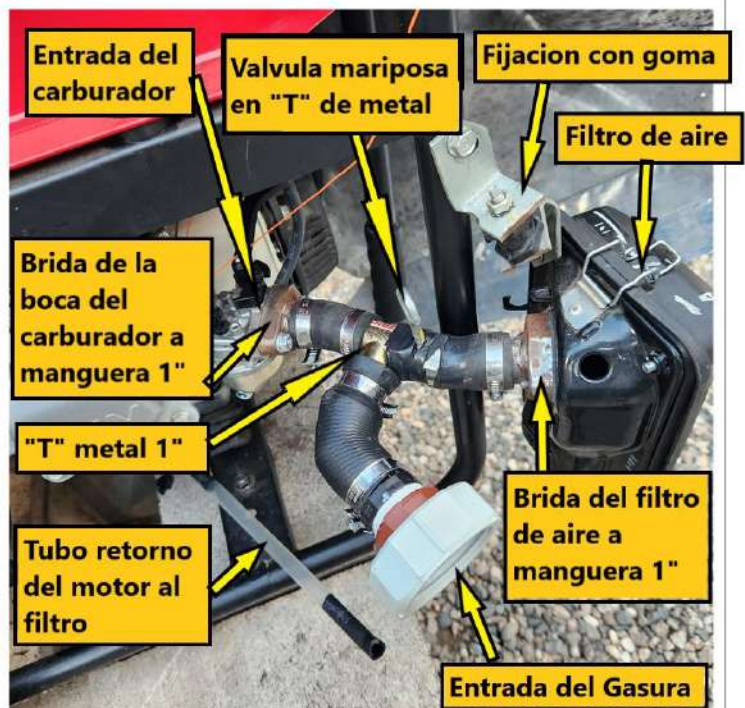
Se retiro el tubo retorno para mostrar la adaptacion.
